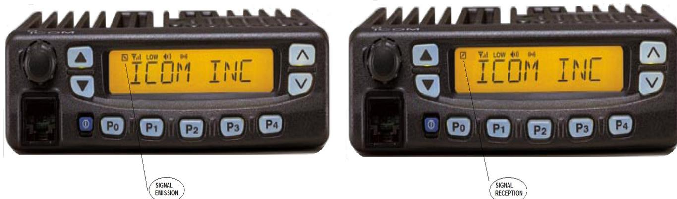
L'affichage des symboles indique que les radios sont bien sur la même fréquence . Côté émission c'est aussi une preuve que la liaison série fonctionne (autrement la radio ne partirait pas en émission) . Coté P400XI, regarder aussi les leds RX et TX du port série concerné :
