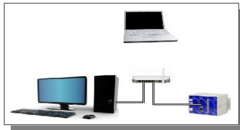
On branche le P400Xi (connecteur RJ45 de la carte PxiBase) sur le routeur par l'intermédiaire d'un câble RJ45 droit. Ensuite, il nous faut raccorder l'ordinateur au routeur; soit en connexion WiFi si les deux produits supportent cette fonctionnalité, soit par un câble RJ45 droit qui relie la carte réseau de l'ordinateur au routeur.
