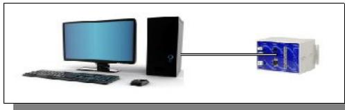
On relie directement le P400Xi (par l'intermédiaire du port RJ45 de la carte PxiBase) au connecteur réseau de l'ordinateur. Le type de câble est un câble RJ45 croisé.
